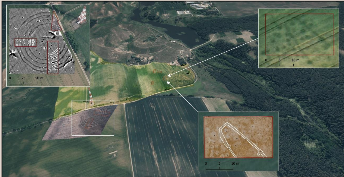
Fot. 1. Syntetyczny obraz terenu wykopalisk (trójwymiarowe zobrazowanie terenu oparte na ortofotomapie i laserowym skaningu LiDAR; fotografii lotniczej i zobrazowaniu geomagnetycznym rondela oraz fotografii lotniczej domu z sąsiadującej osady)
